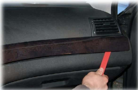
Im ersten Schritt wird die Zierleiste auf der rechten Seite vorsichtig mit Hilfe eines Entriegelungswerkzeuges ausgebaut. Vorsicht, bei Wurzelholzapplikationen kann es beim unsachgemäßen Ausbau zu Lackschäden kommen.
