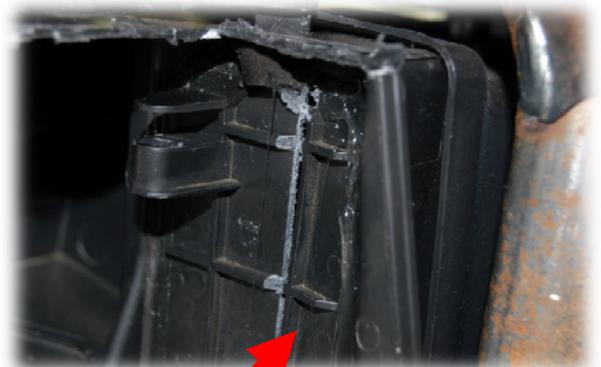
Den abgeschnittenen Teil wieder in den Lüftungsschacht einkleben (mit Superkleber, Heißkleber, Silikon,...) Achtung! Der hintere Teil muss noch drehbar bleiben (auf Funktion überprüfen).
