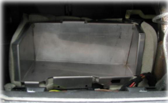
Tip: Es empfiehlt sich, die Biegekanten mit Silikon oder Heißkleber auszufüllen, damit keine Luft von der Lüftung einströmen kann. Desweiteren sollte nun auch noch der Motorarm der Lüftungsklappen auf Leichtgängigkeit geprüft werden.
