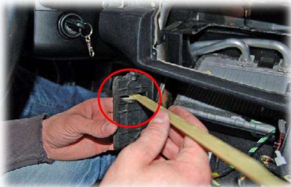
Den mechanischen Arm aus der Lüftungsklappe links (Bild) ausbauen.
