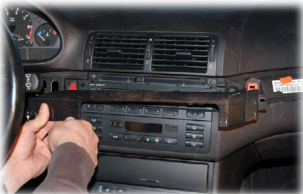
Im zweiten Schritt entfernen wir die Zierleiste oberhalb des Radios, auf der linken Seite mit einem Entriegelungswerkzeug leicht nachhelfen.
