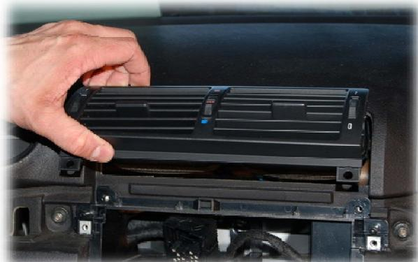
1.4. Klimabedieneinheit ausbauen / *remove climate control unit*
