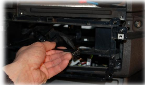
1.6. Ablagefach mit Sitzheizungseinheit ausbauen / *remove pocket with seat heating unit*
