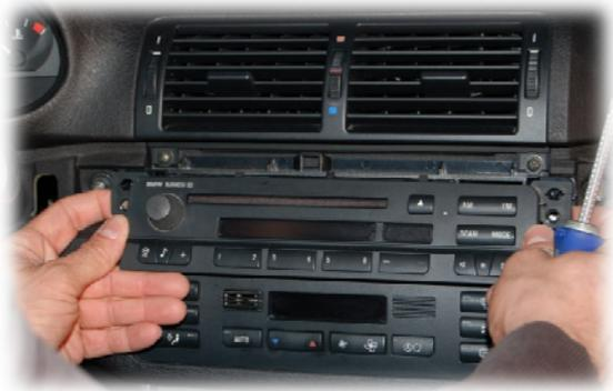
Das Radio herausziehen und das Anschlusskabel sowie die Antennenleitung abstecken.
