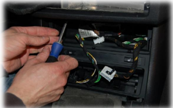
Klimabedienteil anschließen und einsetzen, sowie die Ganghebelabdeckung einbauen.
